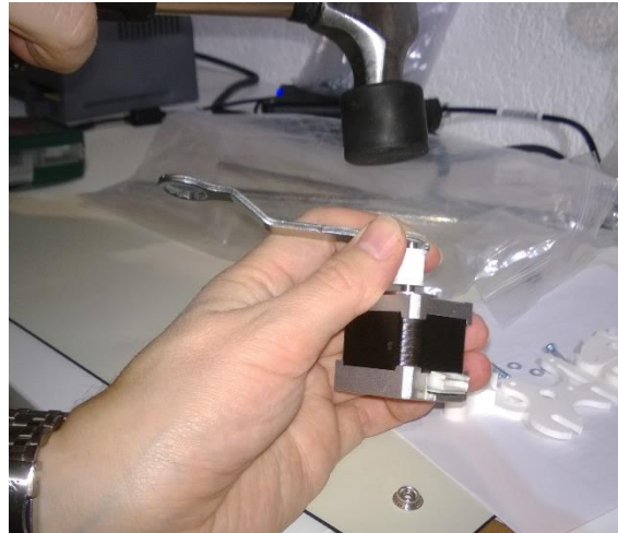
Abbildung 10: ...mit Abstützung der Motorachse durch Druckknopf der Antistatikmatte 😊
