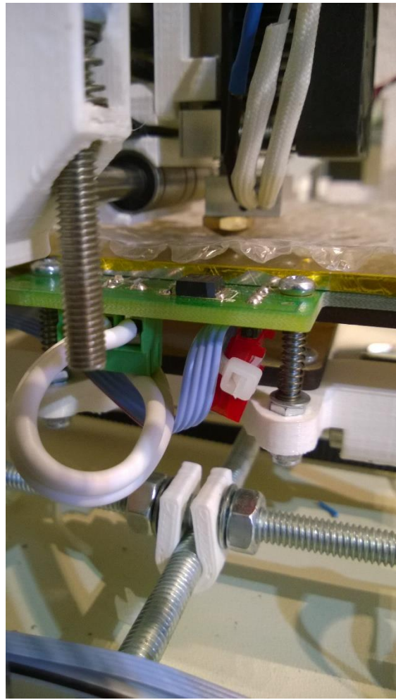
Abbildung 21: Heatbed-Control-Cable IDT-Stecker (rot).
