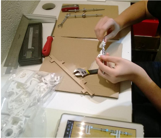
Abbildung 5: Vorbereitung der Längsverbindungen.
